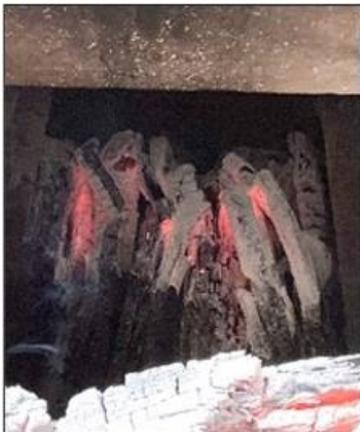
**12:50** 煙道出口温度が、今回目標とした **80℃** を超えてきたため、焚き止めとした（窯内天井温度：**405℃** 煙道出口温度：**80℃**）。下部石板で焚き口を閉鎖、通風口はレンガ 8 枚中 2 枚分のみ開放、煙道出口ダンパーは全開の状態とした。
