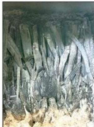
最前列の炭材上部でも灰化が見られず、全体的には良好な炭化が進んだように見られた。しかし、出炭を進めていくと、炭材の上に詰めた上げ木が中央より奥の方で多く燃え残っており、炭材下部にはあきらかな未炭部分が多く見受けられるようになった。
